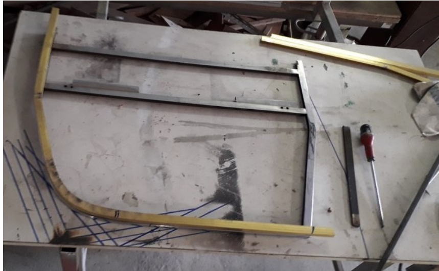
Assemblage de l'angle à la brasure d'argent.
