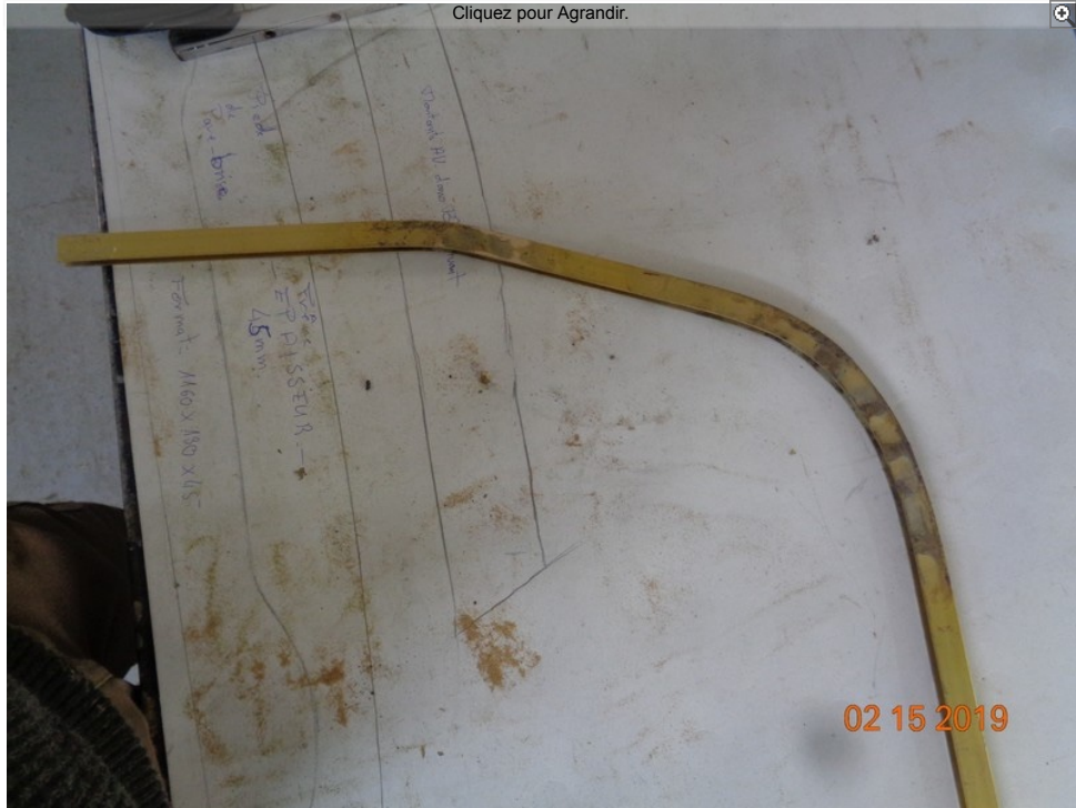
Contrôle par superposition sur un cadre d'origine.
