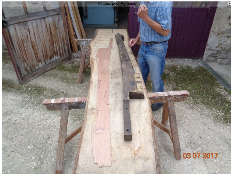
La courbure du bois qui a séché pendant très longtemps, mais probablement dans de mauvaises conditions. 😞
