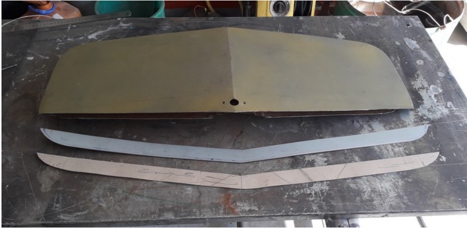
Fabrication des rustines intérieur.
