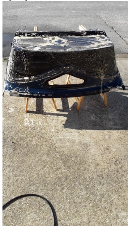
Dégraissage de la tôlerie.
