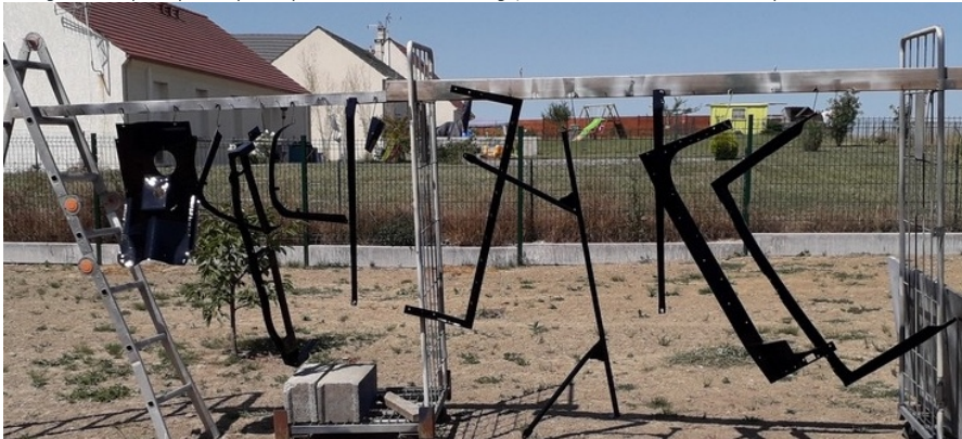
Pour certaines une application d'un bloqueur de rouille type Frameto.
