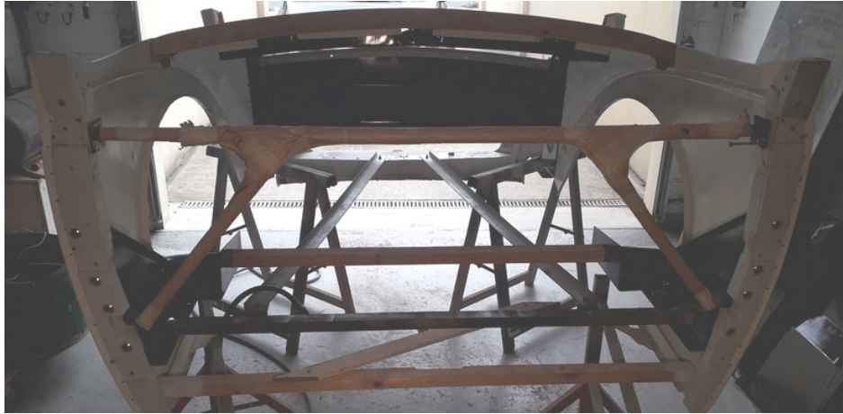
Assemblage des divers éléments qui resterons dans la partie arrière. Boîte à eau, gouttière, supports de charnières montants de portes etc..
