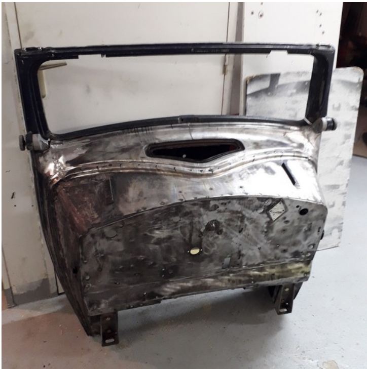
Un détail, une fois les angles débarrassés de l'étain c'est pas très beau.
