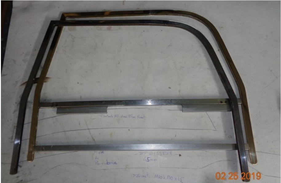
Polissage final et mise en stock en attente du chromage.
