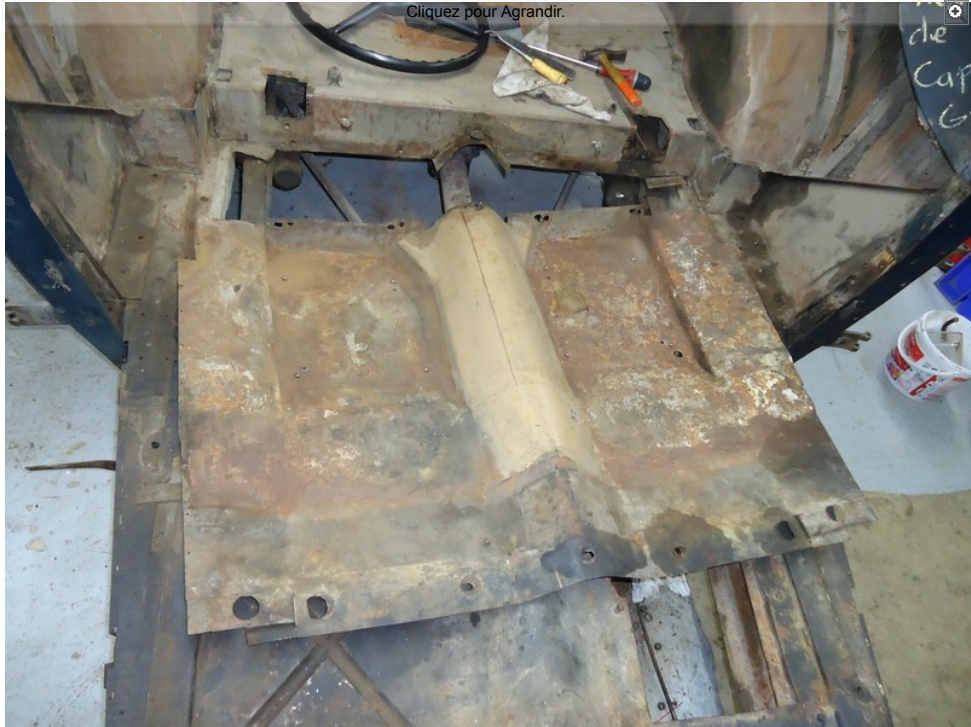
Les planchers et l'avant sont déposés.
