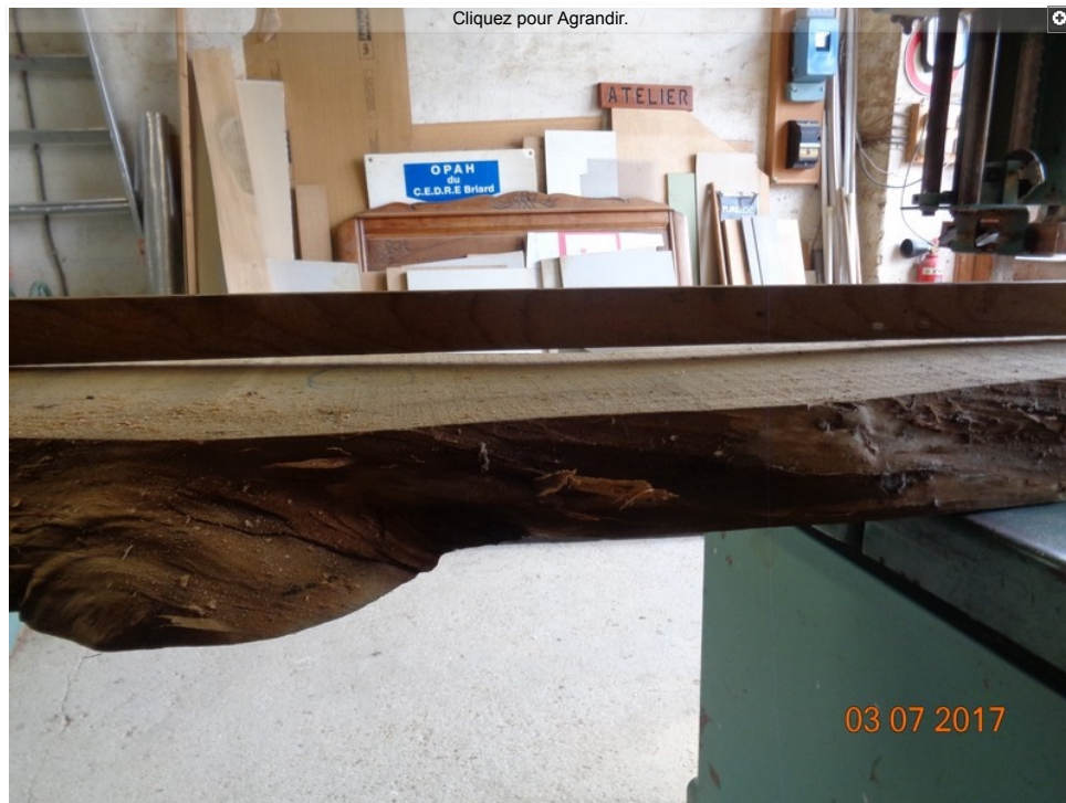
La courbure du bois qui a séché pendant très longtemps, mais probablement dans de mauvaises conditions. 😞
