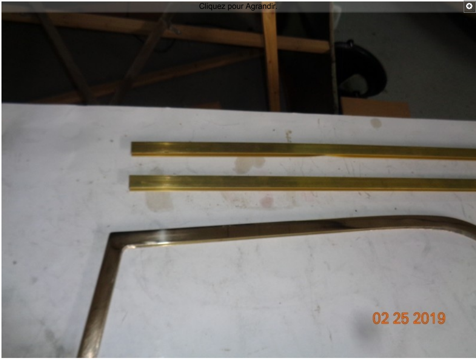
Polissage final et mise en stock en attente du chromage.
